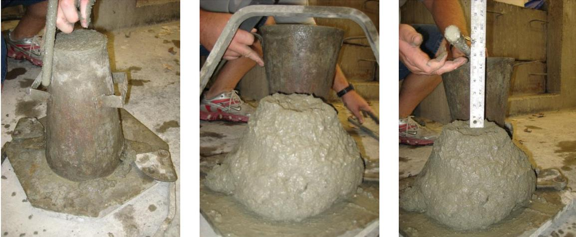
**Figure 29. Slump test**
